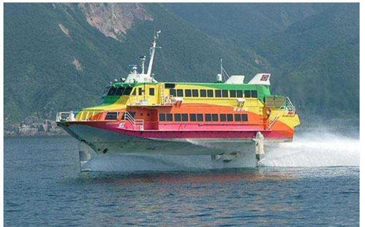
図1 高速ジェット船(東海汽船): セブンアイランド虹(全長約27m, 旅客定員254名) (from https://www.tokaikisen.co.jp/ourship/jetship/ )
