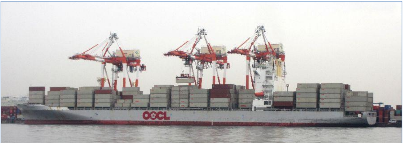
青海コンテナ埠頭のコンテナ船とガントリークレーン（gantry crane） 参考：ガントリー（gantry）とは、複数の高脚の上部に水平な梁を備えた門型の構造物を指す単語
