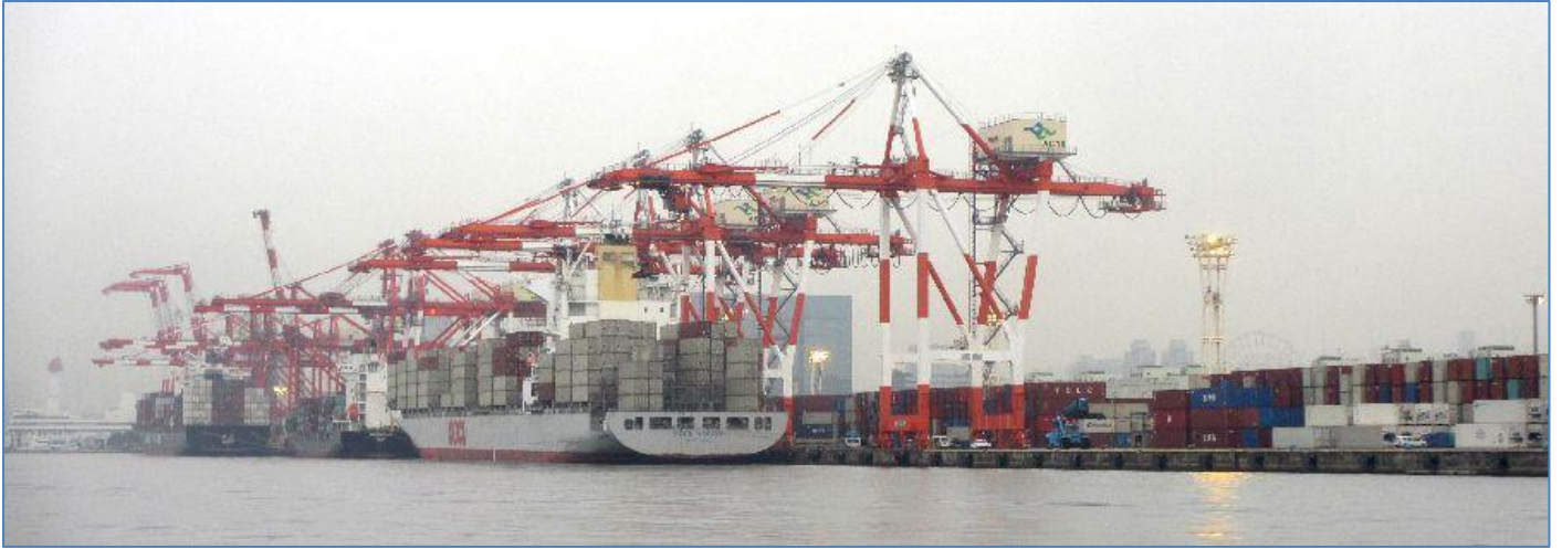
青海コンテナ埠頭のコンテナ船とガントリークレーン（gantry crane） 参考：ガントリー（gantry）とは、複数の高脚の上部に水平な梁を備えた門型の構造物を指す単語
