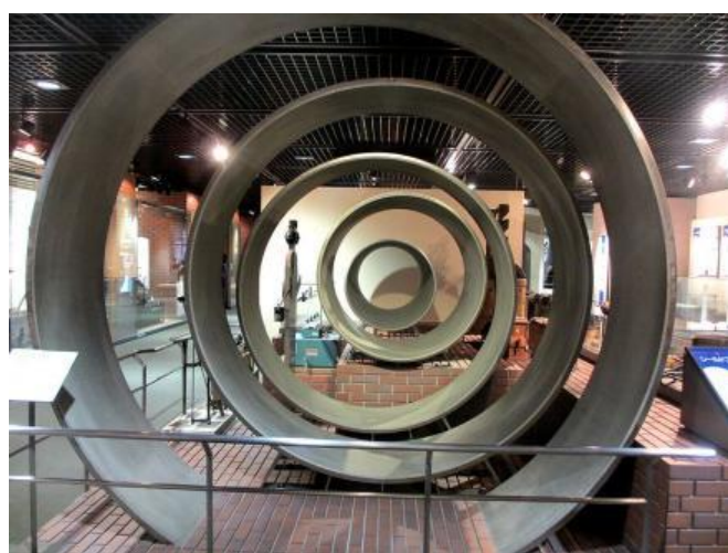
図 6 左図の最大口径の管は、2,900mm あり、日本最大：羽村取水堰から村山・山口 貯水池までの導水管に使われています。
